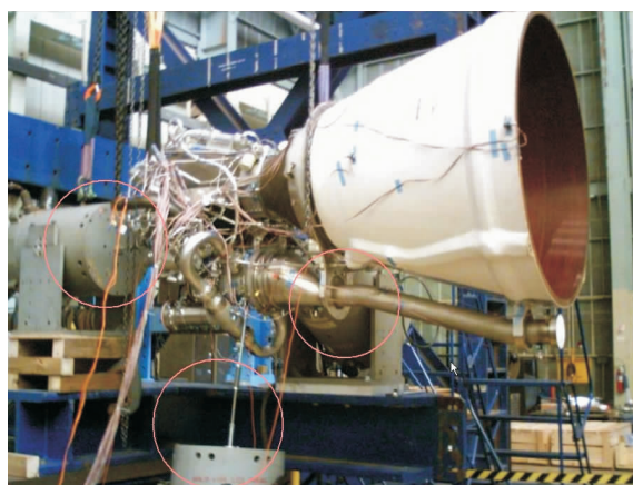
图2 MC-1发动机多源激励试验 [3]
