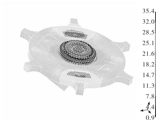
图3 490 N发动机头部仿真温度
