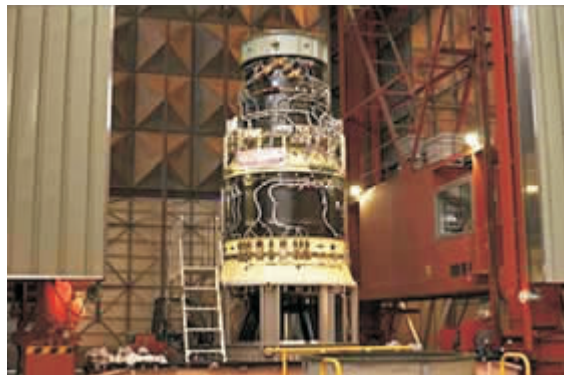
图 1 运用“M-V”发动机技术的“Epsilon”系列火箭上面级发动机
