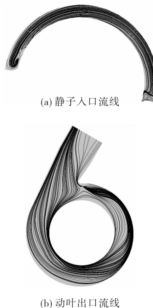
图9 优化后进排气结构内部流线
