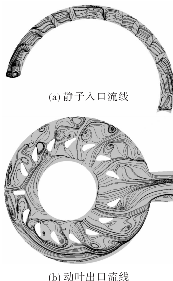
图7 原进排气结构内部流线
