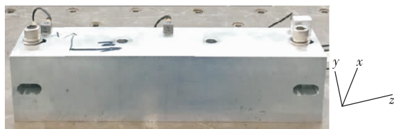
图 1 振动试验夹具
