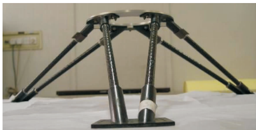
图2 DFH卫星平台发动机复合材料支架
