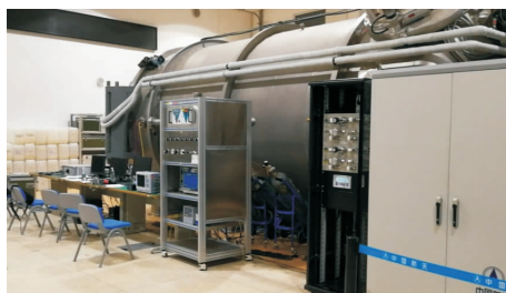
图 3 AF-MPDT 性能测试系统实物图
