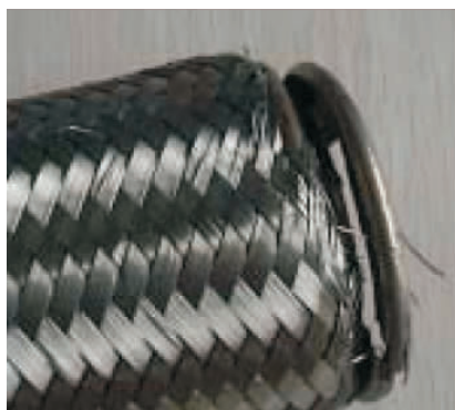
图2 网套局部结构图
