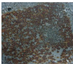
图 1 S-130 不锈钢空气中 12 h 后自然腐蚀形貌
