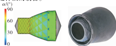
图 12 缠绕成型仿真过程及喷管延伸段产品照片
