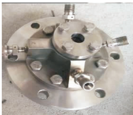
图 6 试验点火器
