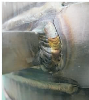
图 2 某结构焊缝开裂
