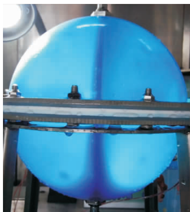
图 12 中性浮力试验贮箱实物图 ( 0.0367 \text{ m/s}^2 )
