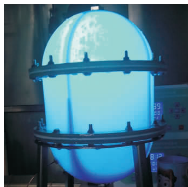
图 14 中性浮力试验贮箱实物图 ( 0.0394 \text{ m/s}^2 )
