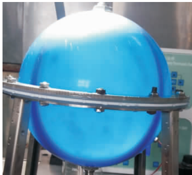
图 7 中性浮力试验贮箱实物图 ( 0.0275\text{ m/s}^2 ) Fig. 7 The tank used in buoyancy experiment ( 0.0275\text{ m/s}^2 )
