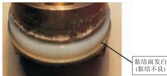
图2 主阀阀芯黏结不良
