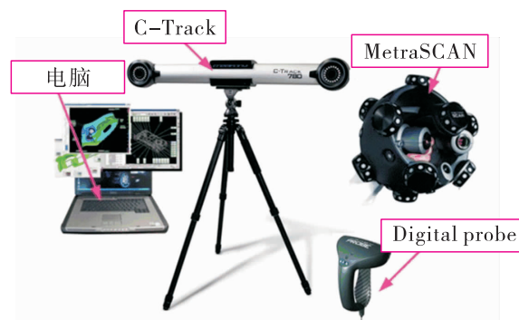
图6 Creaform手持光学测量系统
