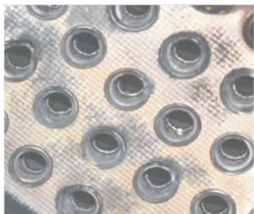
图12 液氧/甲烷发动机第12次试后喷嘴出口结焦情况
