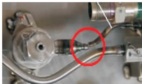
图 1 管路断裂位置
