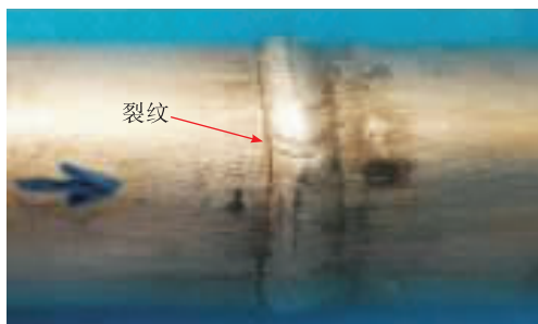
图 9 失效试样外形图(试样 5)
