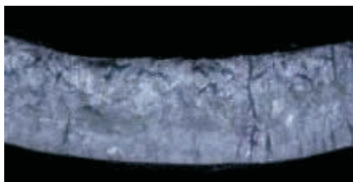
图 10 断口宏观图(试样 5)
