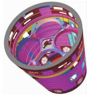
图 8 有限元计算模型 Fig. 8 Finite element calculation model
