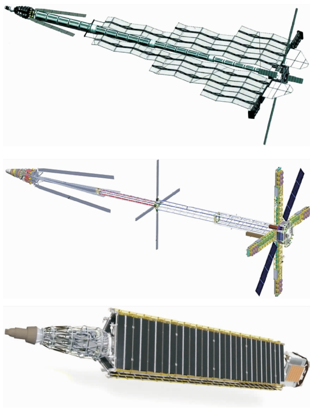
图 3 俄罗斯兆瓦级核动力飞行器结构方案演变
