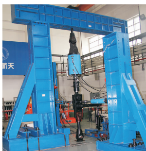
图8 轴承载荷试验系统
