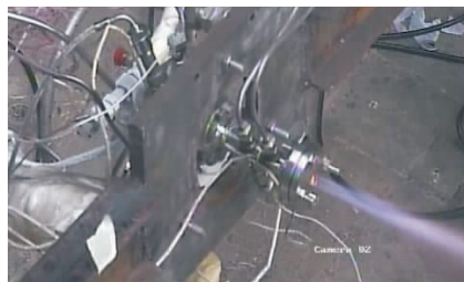
图6 电点火系统点火试验
