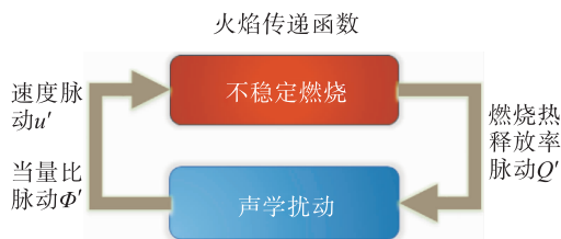
图 1 燃烧不稳定反馈回路
