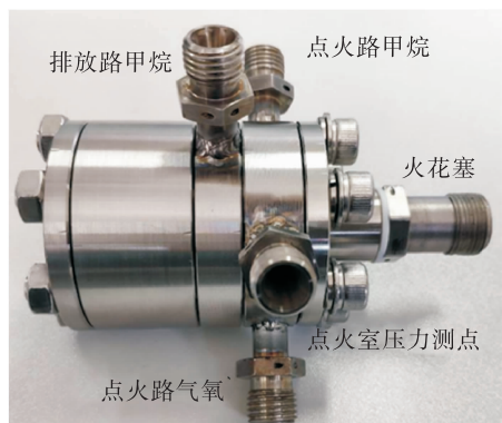
图3 气氧/气甲烷点火器实物图
