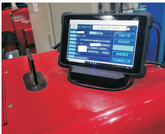
图 9 手持操作终端安装示例
