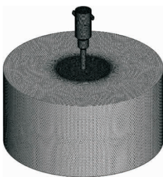
图 3 三维计算域网格及喷嘴局部放大图
