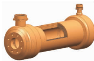
图 1 多层嵌套钎焊铣槽式换热器局部剖切示意图
