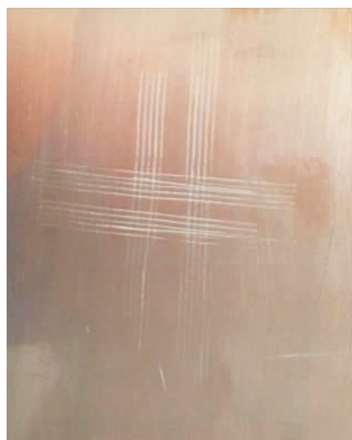
图 8 划格法试验后试片外观
