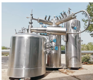
图 18 北京航天试验技术研究所设计的浆氢制备系统
