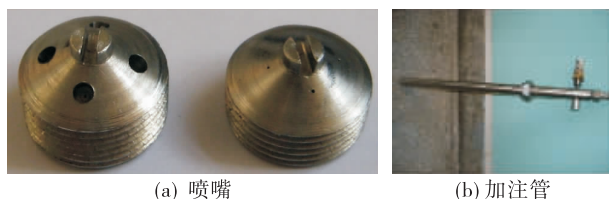
图21 两种形式的喷嘴和配套加注管实物图
