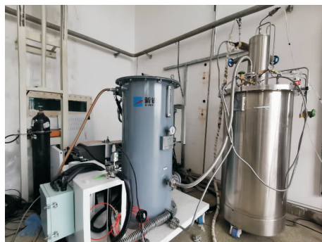
图 12 北京航天试验技术研究所设计的液氧过冷系统
