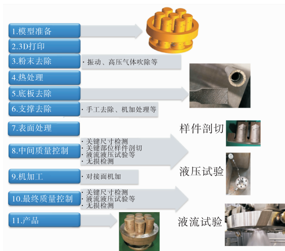
图 2 3D 打印喷注器生产步骤
