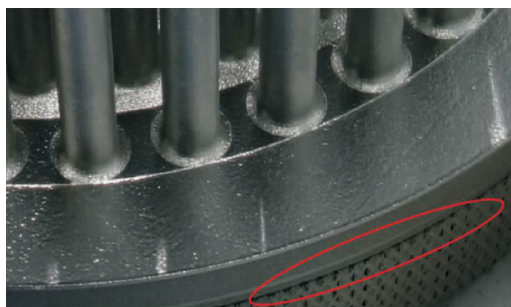
图 8 支撑开裂位置
