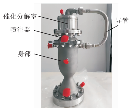
图 4 基于 3D 打印的过氧化氢/煤油推力室
