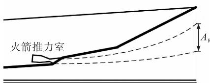
图8 火箭推力室羽流虚拟流管
