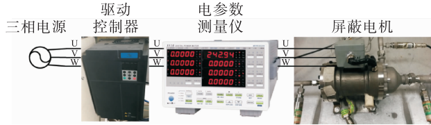
图 2 电动泵供电及电参数测试示意图
