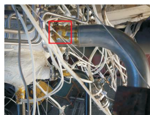
图4 典型管路应变测点
