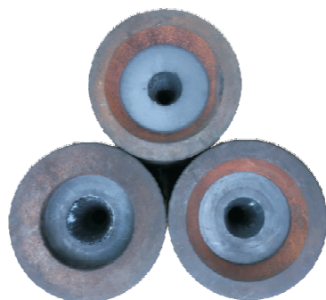
图 3 试验用固体火箭发动机 (端面)
