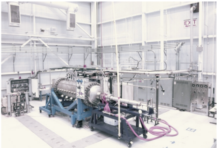
图 5 美国核热火箭元件环境模拟器 Fig.5 Nuclear thermal rocket element environment simulator
