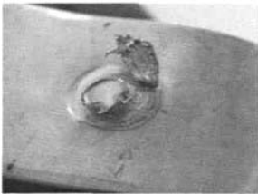
图 6 焊点中的飞溅
