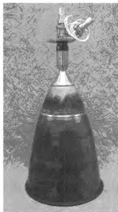
图 1 热试车后的 AMBR 样机
