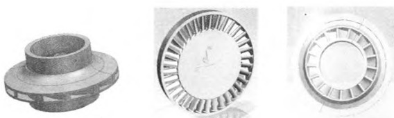
(a) 离心轮 (b) 涡轮盘 (c) 涡轮静子
