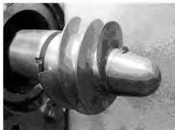
图 1 变螺距诱导轮
