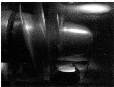
图 9 诱导轮压力面气蚀( Q=1.1Q_d , \sigma=0.1366 )
