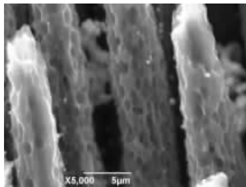
图 8 碳纤维发生氧化烧蚀作用的微观形貌 SEM 照片
