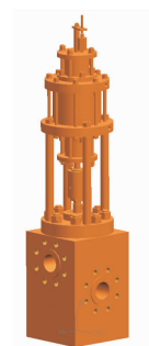
图 5 气动式快速换向阀
