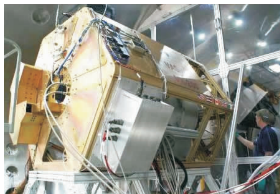
图 2 VASIMR 推力器样机图
