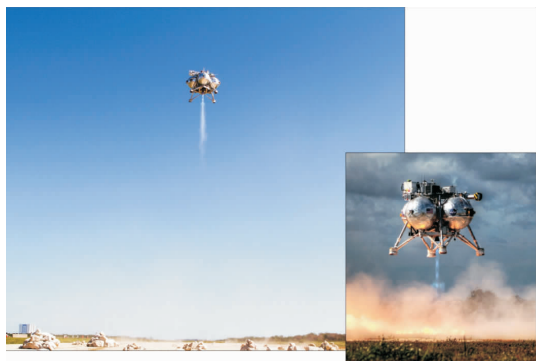
图 1 Morpheus 着陆器在 KSC 星球地貌模拟降落场自由飞行及自主着陆
