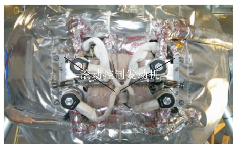
图 3 Morpheus 液氧/甲烷滚动控制发动机
