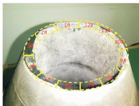
图8 C/SiC 复合材料喷嘴出口段冲蚀磨损后宏观照片
