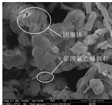
图1 碳纤维增强聚四氟乙烯粉料微观结构
