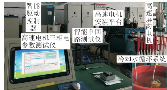
图 2 高速屏蔽电机湿式空载试验系统
