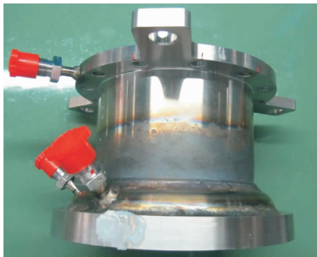
图 7 试车后推力室身部外侧照片
