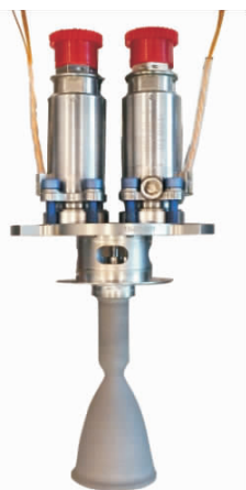
图 1 双组元离心式喷注器 10 N 发动机外形
